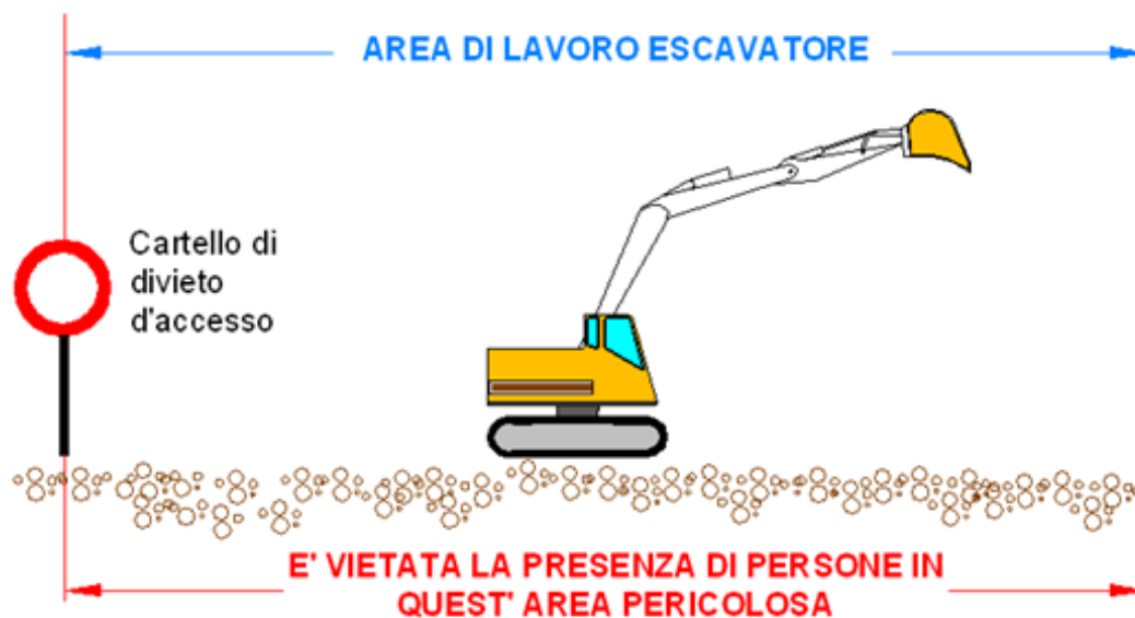
Esempio di messa in sicurezza area intorno all'escavatore
